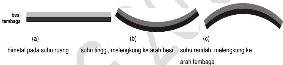
Gambar 3.10. Pelengkungan bimetal pada suhu tinggi dan rendah
